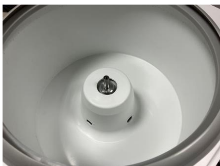
Arbre et chambre du moteur
